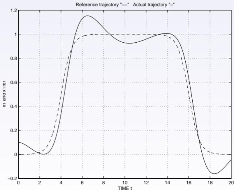
FIG. 3: Trajectoire de référence et réelle (PID pur)
