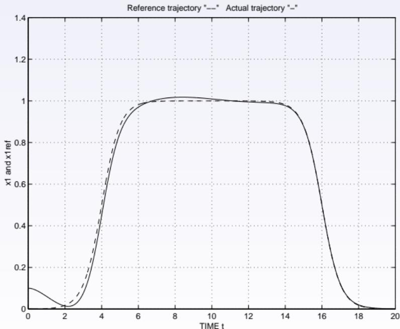
FIG. 6: Trajectoire de référence et réelle (suivi stabilisé par PID)
