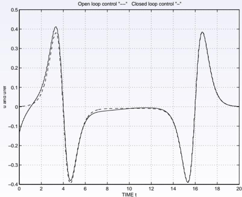
FIG. 8: Commandes en boucle ouverte et appliquée (suivi stabilisé par PID)
