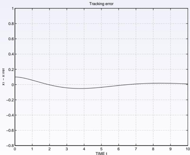
FIG. 7: Erreur de suivi (suivi stabilisé par PID)
